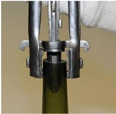
Fig. 7 a, b, c. Fers à embouchures de 1856 en situation sur col de bouteille parisienne ; © O. Boilly, Musée d'histoire naturelle de Lille, inv. n° MI 7439/279.
